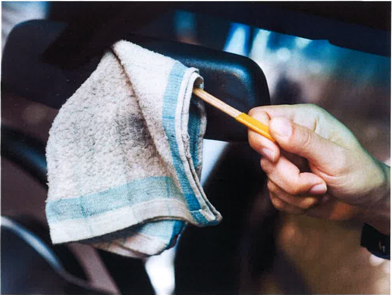
狭い部分の汚れを取るため、自作した道具の先端にタオルをくくりつける＝横関一浩撮影
